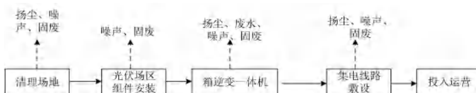
图 2-4 光伏发电场区施工工艺流程及产污节点图
